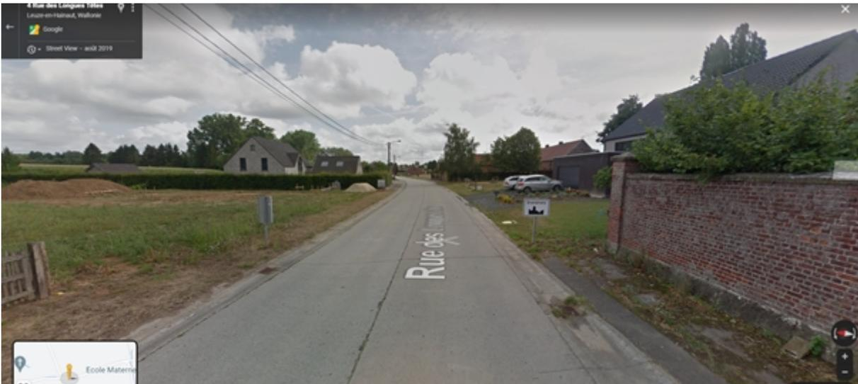
Un radar préventif a ainsi été installé en entrée d'agglomération pour informer les usagers sur leur vitesse et les inviter à lever le pied. Force est de constater, au vu des résultats de l'analyseur, que ce radar n'est pas suffisant pour canaliser les excès et qu'un aménagement physique, modifiant la perception de longue ligne droite et forçant les usagers à ralentir, est nécessaire.
