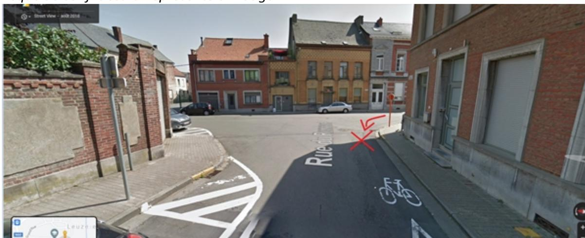
*Afin d'éviter tout risque de collision, il nous semble nécessaire de prévoir un îlot séparateur entre les cyclistes circulant en SUL dans la rue du Rempart et le reste de la circulation.*
